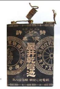
凍結して使えない等の欠点がありました。そこで本格的に『乾電池』の開発に取りかかりました。 日中は会社の仕事、夜は物理学校付属の職工となって電池の開発に取り組みました。正極に薬品が しみ出して、金具が腐食して使えなくなることが問題で、この改良に苦労していましたが、炭素棒に パラフィンを含浸するこをにより明治 20 年『乾電池』を発明しました。
