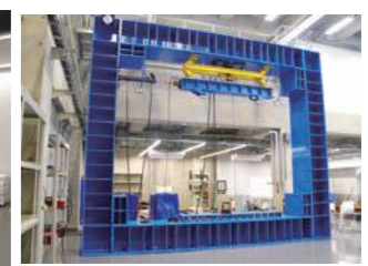
大型構造実験用反力フレーム
